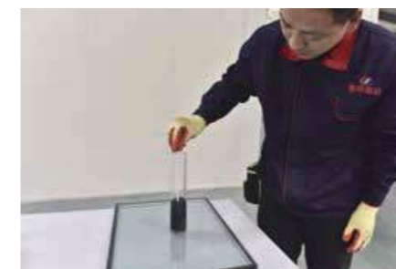
Dew point test 露点实验
