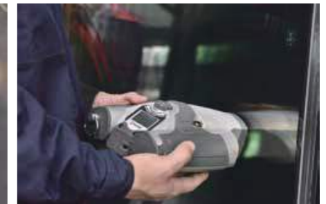
IGU argon gas detection 中空氩气检测
