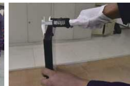
IGU thickness inspection 中空厚度检验
